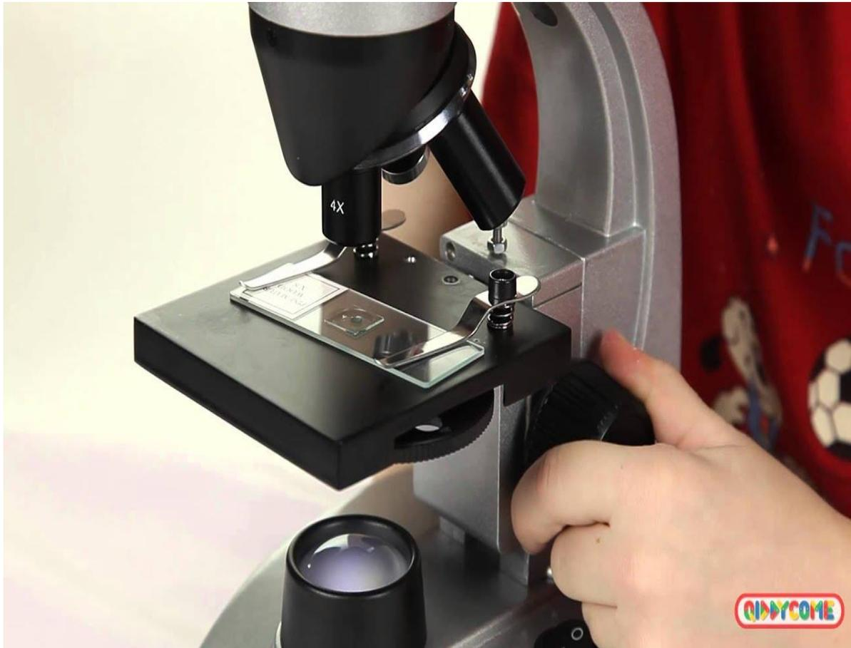
*✓ Предметный столик относится к механической части микроскопа*
